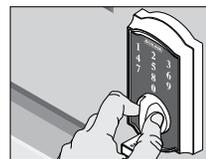
4. Remplacez la pile déchargée par une nouvelle pile de 9 volts. Consultez la section **Remplacer la pile** ci-dessus.
